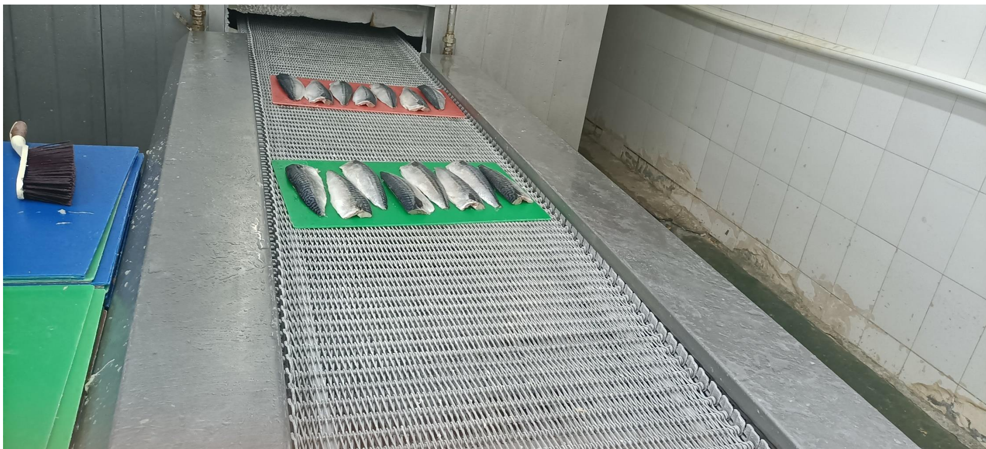
スパイラル冷凍（冷凍温度 -45^{\circ}\text{C} 以下、冷凍時間約 40 分）
