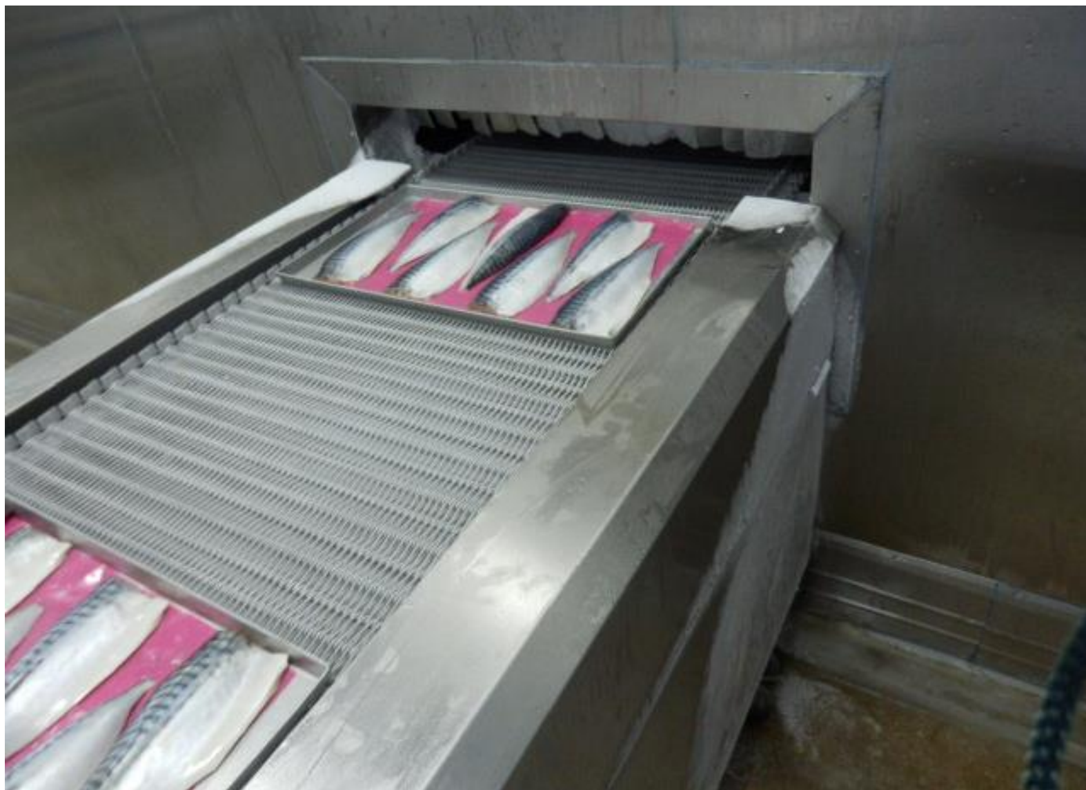
スパイラル冷凍（冷凍温度 -45^{\circ}\text{C} 以下、冷凍時間約 40 分）
